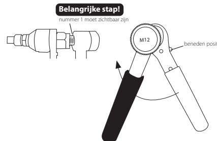
**C DE TOOL VOORBEREIDEN OM EEN BLINDKLINKMOER TE ZETTEN:**
